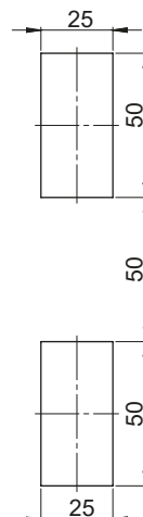
Вид и размер монтажных отверстий
